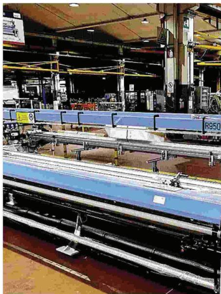
Telaio R950EVO in produzione allo stabilimento di Colzate
